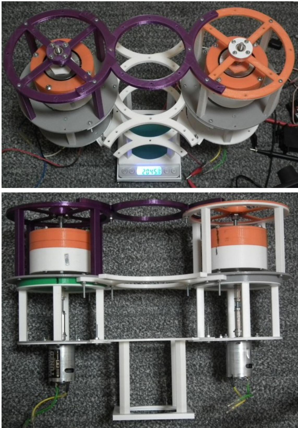
この写真は電線をモーターに接続していないので、実験での重量とは多少異なる。
