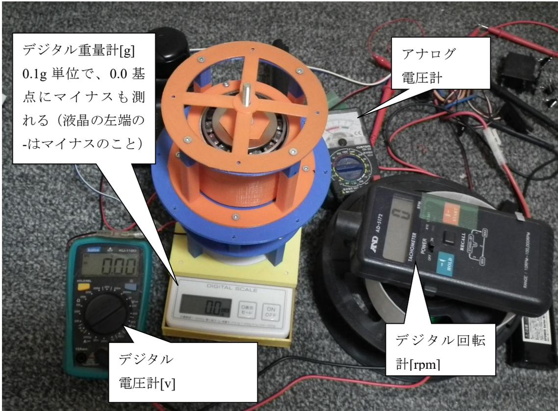
初期の構想では、円錐コロ軸受けの中心を上部の十字の板バネ相当にボルトで固定して外側を回そうとしたが、機械抵抗が大きかったので、板バネ相当を外して実験してみることとした。外側から回すことで内側を固定しなくても順回転になるから特に固定する必要はない。さらに2連装の円錐コロ軸受け本体なしの下部のタービンのみでの推進力も計測すべきとなり、以下の3つの実験をした。
